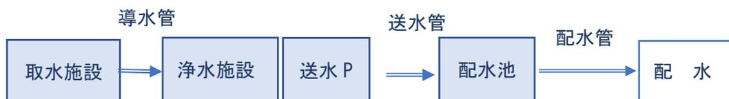
図 2.6 浄水処理フロー図
