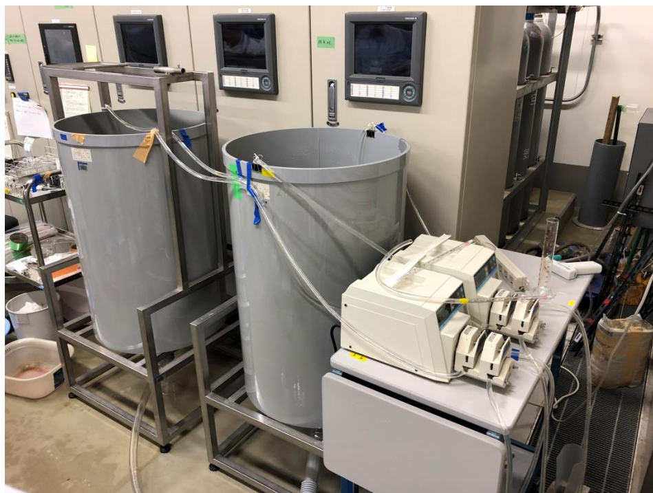
写真 5 連続通水実験用配水タンクおよび定流量送液ポンプ
