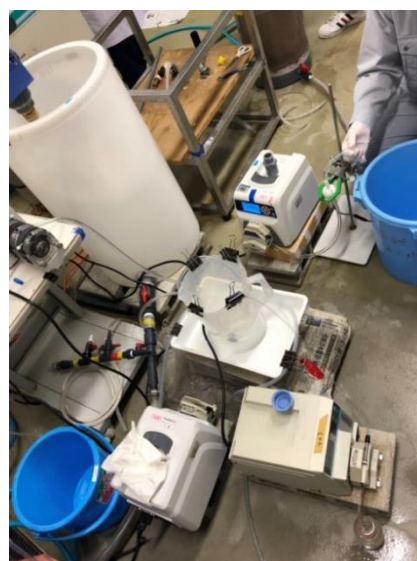
写真 7 小型 UV-LED への連続通水実験
