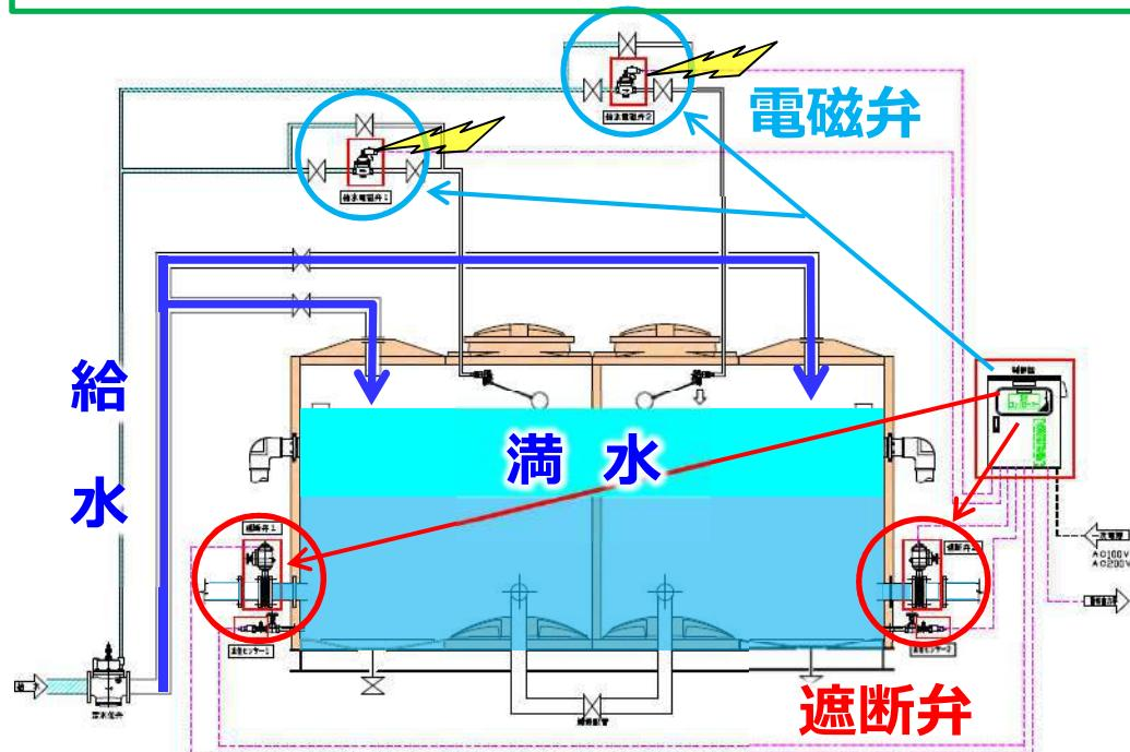
地震感知で出口を遮断すると同時に注水にする事で「最大限の水を確保」するシステムです。
