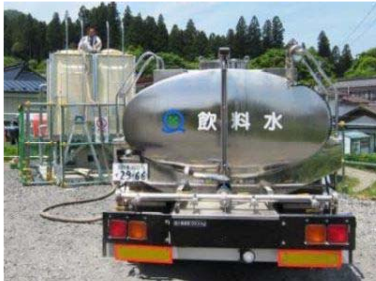
写真8 受水槽への給水には大容量の加圧ポンプ付き給水車が活躍（出典：（公社）日本水道協会 岩手県支部「東日本大震災における応急給水活動等の記録」（2012年12月5日増訂））
