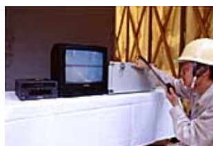
ロボットから送られてくる画像をモニターで確認しながら、その動きを制御する
