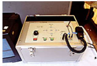
管内調査ロボットシステムの地上制御装置
