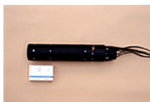
ロボットの長さは286mm（下はタバコ）
