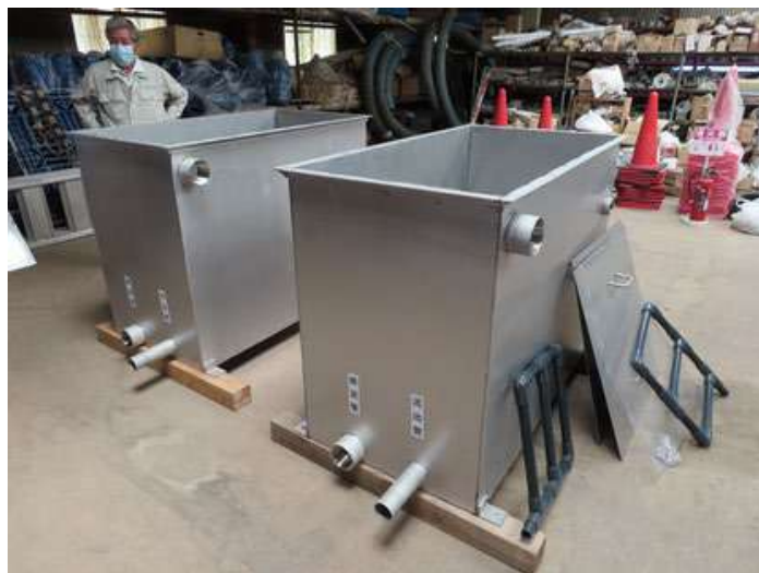
簡易緩速ろ過装置本体
